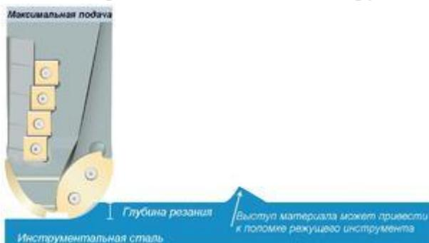
OptiPath отслеживает количество удаляемого материала и корректирует скорости подачи, поддерживая постоянную толщину стружки. Это позволяет не только обеспечить более эффективную механическую обработку, но и защитить станок и инструмент от поломки.
