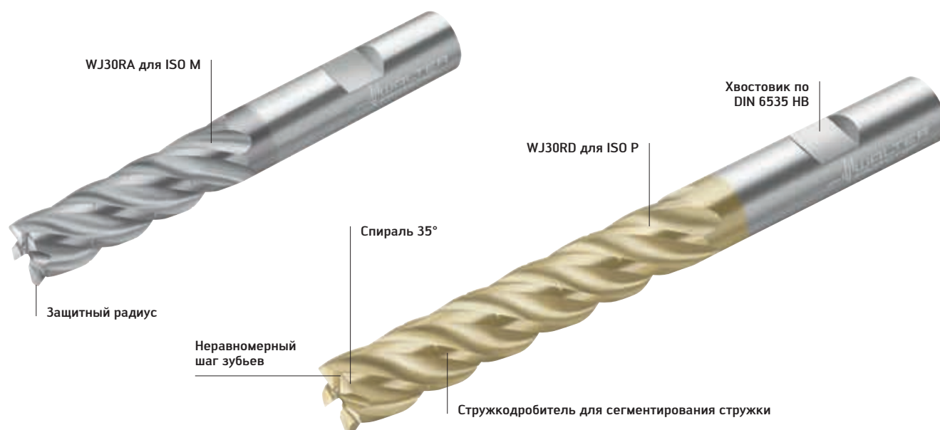
Фрезы твердосплавные MD133 Supreme
