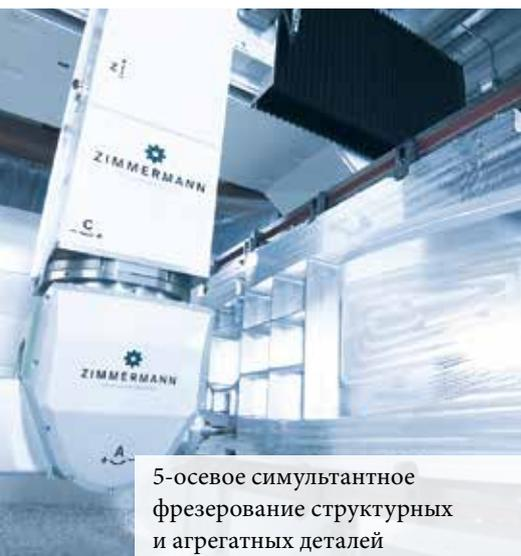
5-осевое симультантное фрезерование структурных и агрегатных деталей
