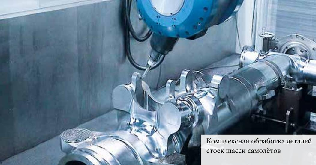
Комплексная обработка деталей стоек шасси самолётов
