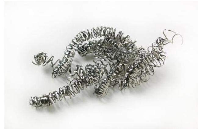
Рис 2: Неправильное стружкообразование
