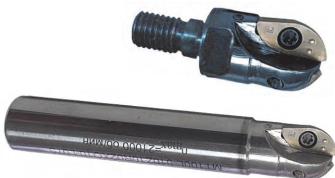
Для правильной установки метки на пластине должны совпадать с соответствующими метками на корпусе фрезы
