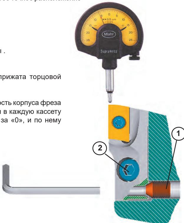
Подобная настройка фрезы необходима только в случае особо высоких требований к поверхности при чистовом фрезеровании с небольшими припусками. Во всех остальных случаях сохраняется базовая установка кассет с опорой на торцовую поверхность корпуса, выполняемая изготовителем.
