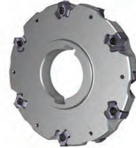
Фрезы толщиной 4 и 5 мм со специальными пластинами с 6-ю режущими кромками, которые используются поочередно на левой и правой стороне диска фрезы. Основное назначение - фрезерование узких пазов и отрезные работы.
