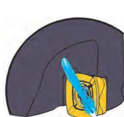
Внутренняя подача СОЖ при обработке аустенитной нержавеющей стали и титановых сплавов
